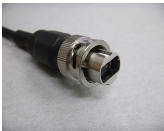
写真3 フルスペック SHV 用光インターフェース (コネクタ部)
