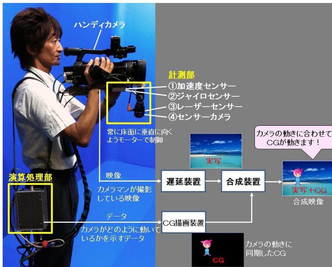
図1 分離型小型ハイブリッドセンサーの外観と構成
