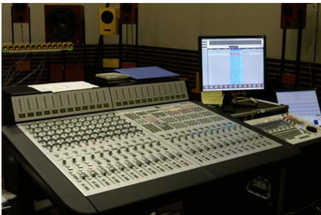
図2 開発した三次元音響 ミキシングシステム
