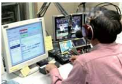
生字幕の制作風景 (リスピーク方式) アナウンサーが音声を要約して復唱し 音声認識装置により字幕変換
